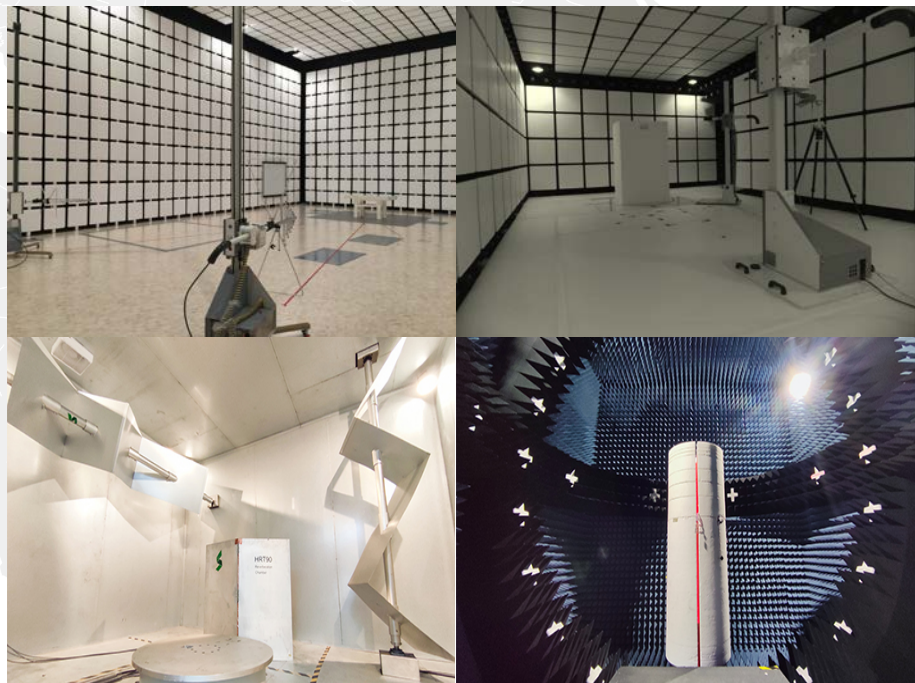
東研信超的全、半電波暗室與OTA測試暗室
